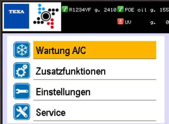
Das Hauptmenü ist einfach und intuitiv zu bedienen und dient als Ausgangspunkt zu allen Funktionen.
