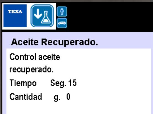
La balanza electrónica permite medir con extrema precisión la cantidad de aceite recuperado durante el servicio de mantenimiento.
